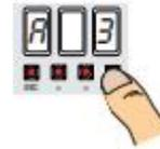
Sélectionner 1 et appuyer sur ENTER pour confirmer l'opération de réglage automatique de la course...
