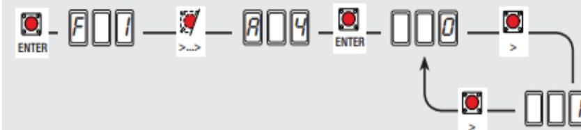
**F 1 (Arrêt Total 1-2)** - entrée N.F. : arrêt du portail avec, par conséquent, désactivation de l'éventuel cycle de fermeture automatique ; pour reprendre le mouvement, intervenir sur le dispositif de commande. Insérer le dispositif de sécurité sur [1-2] ; s'il n'est pas utilisé, sélectionner la fonction 0.
