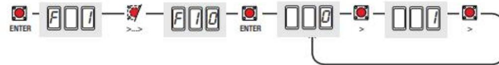
**F 11 (Désactivation Encodeur) :** permet de désactiver la gestion des ralentissements, la détection des obstacles et la sensibilité.
